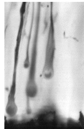
Figure 1 Image d'ombroscopie à faisceaux convergents réalisée pour un propergol aluminisé.
