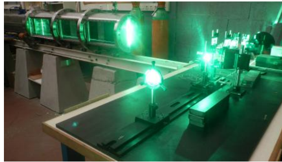
Fig. 1: Photographie du montage optique transformant le plan en nappe laser et de la chambre d'expérience avec une membrane stéréo-lithographiée.
