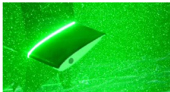
Figure 2: Images de l'écoulement autour d'un NACA0015 pour des mesures de TR-PIV 2D.
